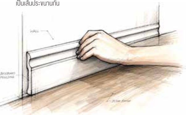
6. วางไม้ไปที่ตำแหน่งที่ต้องการ ใช้แรงกดลงไปที่ไม้บัวหนึ่งครั้ง แล้วดึงออกมาเล็กน้อย เพื่อให้การกาวทำปฏิกิริยาพร้อมเช็ทตัว กดลงไปอีกครั้งและจับไว้
