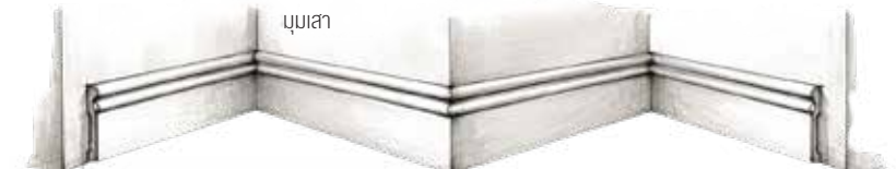
7. ใช้กาวร้อนหยอดเป็นระยะๆ เพื่อให้ไม้บัว YES MOULDING ยึดติดผนังในขณะ ที่กาวฟลึงตะปูทำการเช็ทตัวอยู่
